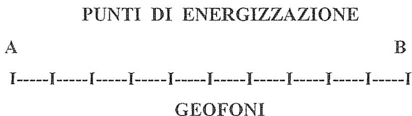
Sono state eseguite complessivamente n. 5 traverse sismiche con stendimenti di 40 m, con di stanziamento tra i geofoni di 5.0 m. E' stata altresì adottata pari a 5.0 m la distanza dal punti di energizzazione al primo geofono.
